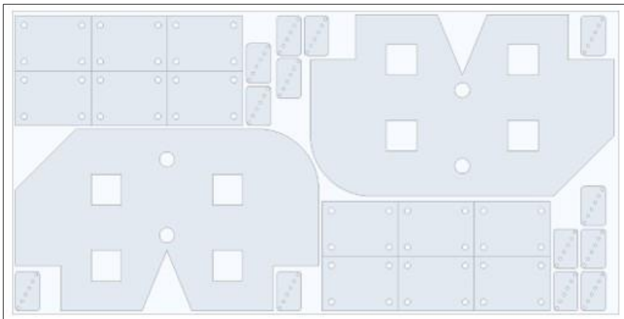
9. ábra: Táblaterv közös kontúrok mentén történő vágáshoz
